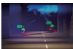
図2. 2D HUD 投影の写真。投影内容(赤)はドライバーから一定な距離のみ。
