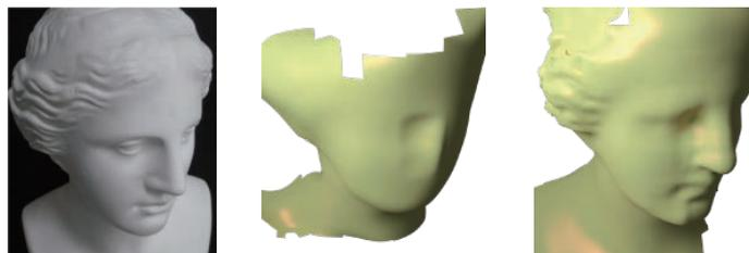
Fig. 2 石膏像を用いた実データでの実験 (左から 真の形状、一枚の距離画像からの形状、高解像度復元形状)
