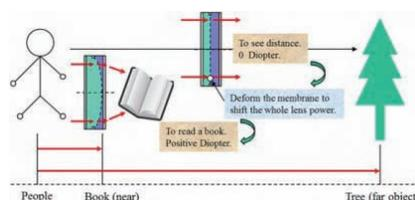
図3 老眼を矯正する屈折力調整可能な可変焦点レンズの概念図
