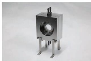
図2 試作した大口径可変焦点レンズの写真
