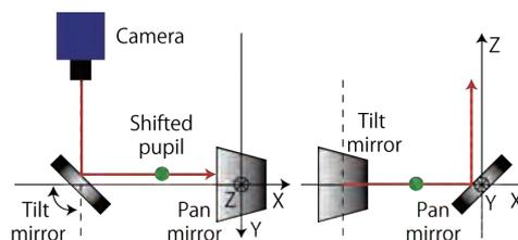
図 2 ミラー式視線モデル
