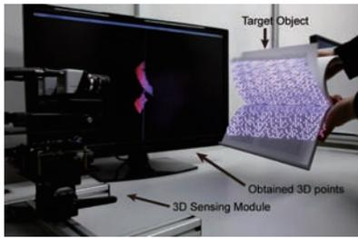
ビデオレート(30Hz)を大幅に上回る速さで撮像から画像処理までを行うことができる高速ビ
