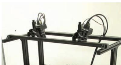
図3 高速3Dジェスチャー認識システム
