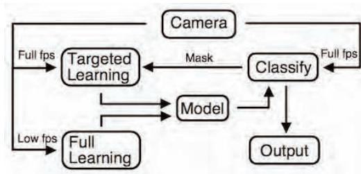
提案システム. 動画画像系列は二種類に分割され、片方は低い更新レートでモデル全体を更新するのに利用し、もう片方は識別結果画像が与えられた際に最大更新レートにおいて急速に変化する領域のモデルを更新するのに利用する。最大更新レートにおける最終的な前景のマスクも同時に生成する。
