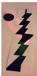
スコアライトは、手描きの線に沿ってリアルタイムに音を生成する楽器のプロトタイプである。同様に、(手、ダンサーのシルエット、建築物などの)3次元の物体の輪郭に沿って音を出すことも可能である。また、このシステムは、カメラとプロジェクタを使用しておらず、レコードプレーヤーにて針がレコードの表面の溝を探索しながら音を出すように、レーザーが絵の輪郭による溝を探索しながら音を出す。音は、描かれた線の垂直方向からの角度、色、コントラストなどの曲がり具合によって生成され、変化する。また、空間性をもっており(下図:4つのデバイスを用いたシステム)、デバイスの探索位置、スピード、加速度などによってパンニング(音の定位の設定)ができる。スコアライトはジェスチャーや形、色などの見えるものを音に変えるといった、人工的な共感覚を実現している。例えば、線の方向が急に変わると、(パーカッションやグリッチのような)離散的な音が起因され、それによってペースとなるリズムが生まれる(一辺の長さによってテンポが定まる)。
