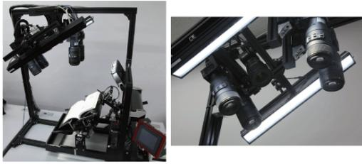
非破壊・超高速の書籍電子化に向けて、めくり動作中に電子化を行うブックフリッピングスキニングが提案された。この構想の下、適応的撮像と自動めくり機を搭載するBFS-Autoが開発された。さらに、電
