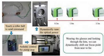
図2 実験装置のセットアップ。眼鏡から近中遠の距離に物体を設置した。
