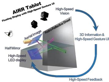
図1 AIRR Tabletの構造
