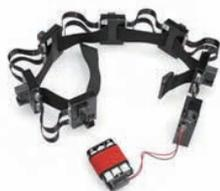
このシステムは、アレイ状の「光学的な触角モジュール」が皮膚上に並べられており、個々のモジュールは距離情報を感知する。そして感知した情報は振動の強弱に変換されモジュール直下の皮膚に提示される。このセンサシ
