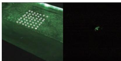
図3 焦点位置可視化(左: 検出した焦点パターンの位置, 右: 背景差分により抽出した1箇所での焦点位置)
