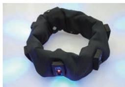
我々は、空間情報を触覚情報に変換することで、ユーザが直感的かつ自然に反応できる装着型モジュールデバイスを開発している。
