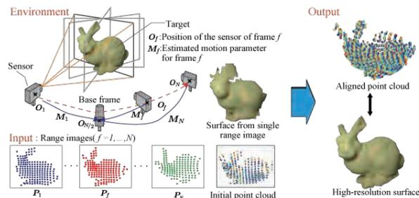
Fig. 1 提案手法のコンセプトと Stanford Bunny を用いた実験結果
