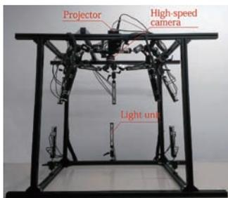
近年、3次元コンピュータグラフィックス(3DCG)により物体の外見をリアルに再現する研究が盛んに行われており、物体表面における光の反射を記述した双方向反射率分布関数(BRDF)を実物体から取得し、リアルな質感の表現に利用することが行われている。しかし、色や光沢感が異なる様々な質感を持った物体から、その複数のBRDF(SVBRDF)を取得する場合には、あらゆる方向から光を当て、あらゆる方向から撮像し、得られた大
