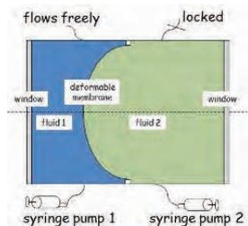
図1 大口径可変焦点レンズの仕組み
