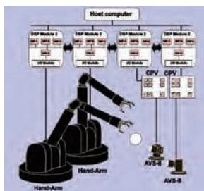
実環境において、投げる・捕るなどに代表されるような動的な操り動作を実現することを目的として、視覚フィードバックに基づく高速マニピュレーションシステムを開発した。こ
