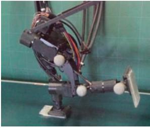
高速ロボットハンドの開発およびその応用で培われた技術を基盤として、新たに高速ビジュアルフィードバックを用いた二足走行ロボットシステム(ACHIRES)を開発しました。このシステムは、独自
