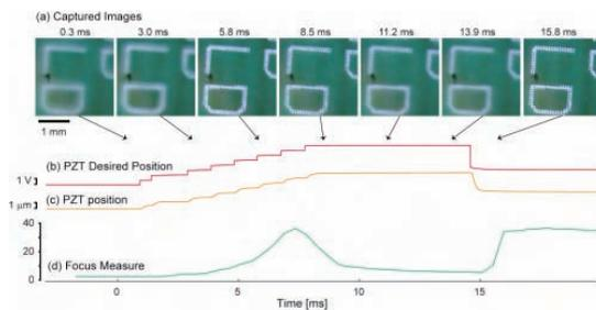
図2 高速フォーカストラッキングの実験結果。
