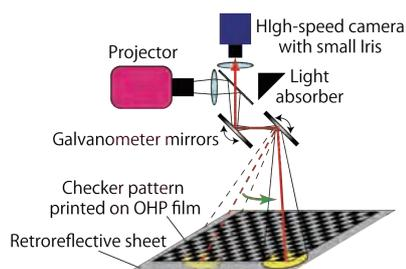
図 1 校正時におけるシステム構成 (被写界深度増大)
