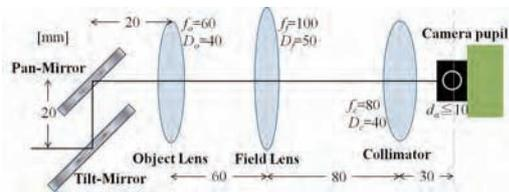
図1 サッカドミラーのセットアップ
