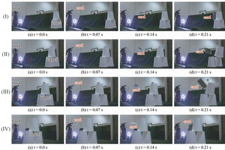
図2. カップへのカード投擲の実験結果(連続写真)
