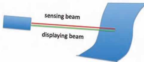
レーザーを利用したセンシングディスプレイシステムは、従来のプロジェクターとカメラを利用したシステムに対して様々な利点を持っている。
