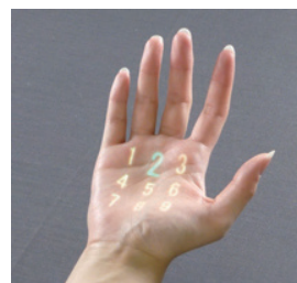
図 4 動く手に表示される映像 (触覚刺激も表示されている) Fig.4 Picture displayed on a moving hand. (Tactile sensation is also displayed.)
