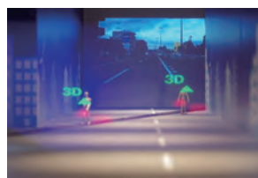
図4. 3D HUD 投影の写真(後ろに合焦)。投影内容(緑)はドライバーから複数の距離に描画可能。
