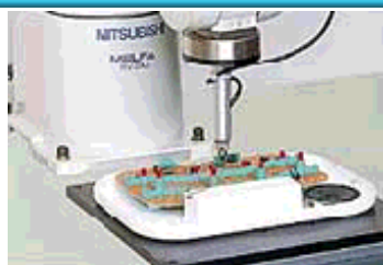
電機・電子部品類の組付け
