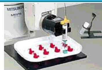
接着剤の塗布，シーリング
