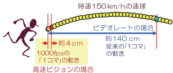
注：サンプリング定理は、対象の動きを把握するには対象のダイナミクスに対して十分なサンプリングレートが必要であることを示しています。一方、一般的に用いられるサーボモータのコントローラは、一部の特殊なものを除いて、最大でも 1,000Hz のサンプリングレートが用いられていますので、1,000fps は実用上十分なサンプリングレートと考えられます。
