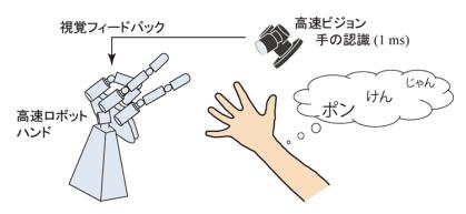
本システムは、高速ビジョン、高速ロボットハンド、コントローラから構成されています。 高速ビジョンは 1,000 fps で画像取得および画像処理を行い、高速ロボットハンドは 0.1 秒で 180 度の開閉運動が可能で瞬間的な動作を実現し、コントローラはビジョンやロボットハンドの入出力および制御を 1ms 毎に行っています。
