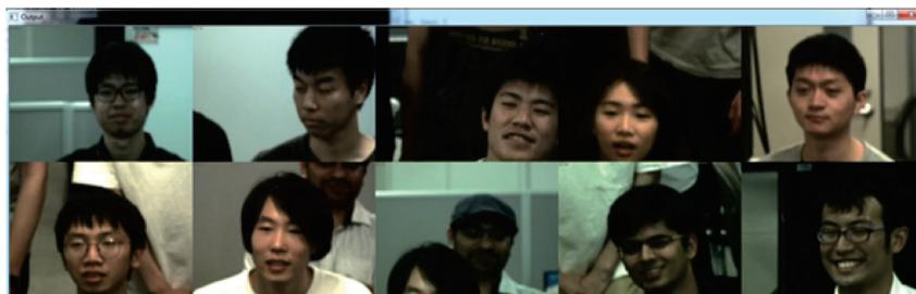
マルチスレッドアクティブビジョン。全体を高速で撮影し、対象部分だけを切り取ることで、複数台のカメラを使ってズームで撮影しているのと同じ認識が可能になる
