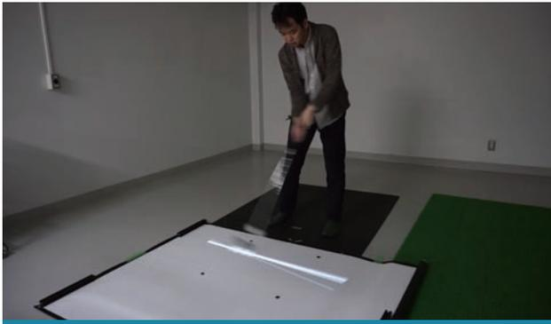
ゴルフのクラブヘッドが描く軌道を計測してリアルタイムで床面に投影
