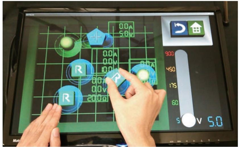
3次元テーブルトップインターフェース。裸眼立体ディスプレイ上に表示された仮想物体を直接手で触れて動かすことができる
