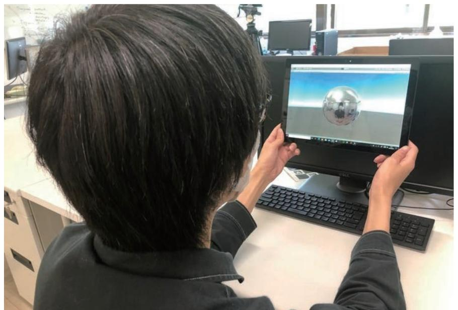
ディスプレイ前面のカメラで撮った人物の画像に、「GAN（敵対的生成ネットワーク）」で推定した周辺画像を組み合わせ、金属物体への周辺シーン全体の映り込みを再現する
