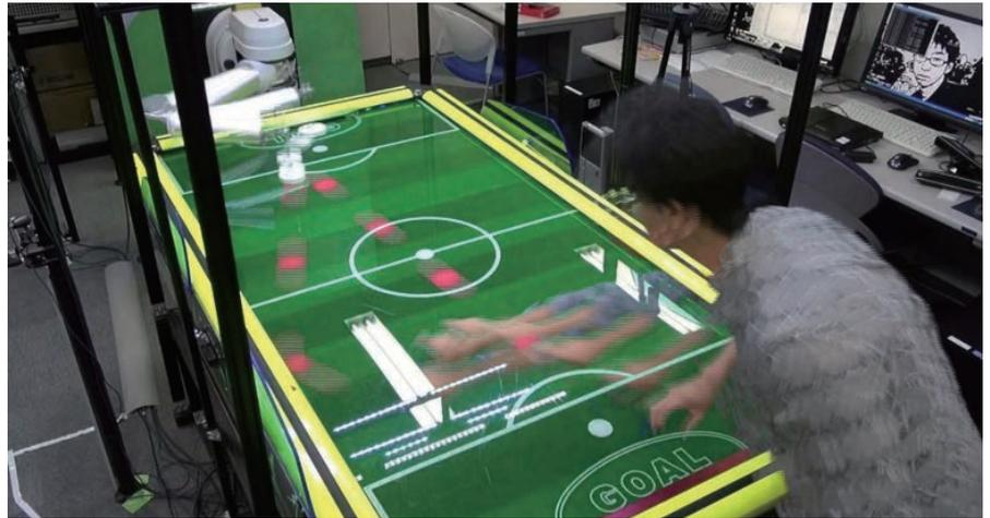
エアホッケーロボット。高速ビジョンと画像処理機能を使い、4自由度の腕型ロボットで器用にパックを打ち返す
