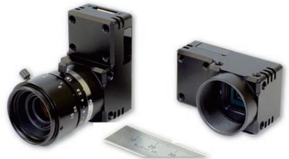
実用化されたソニーのチップを使った高速ビジョンカメラ。並列処理回路を内蔵し、高速画像処理を実行できる
