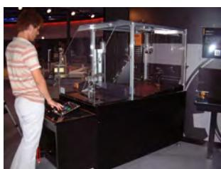
投げ込まれたボールの軌道をビジョンによって瞬時に判断してキャッチすることができる。超高速ロボットハンドシステムを開発した。このシステムは、1ms(0.001秒)で画像
