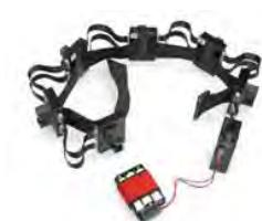
このシステムは、アレイ状の「光学的な触角モジュール」が皮膚上に並べてあり、個々のモジュールは距離情報を感知する。そして感知した情報は振動の強弱に変換されモジュール直下の皮膚に提示される。このセンサシステムは、人が、微生物の纖毛、昆虫の触角や哺乳類の髄のように、皮膚と直接接していない対象に触れた感覚を得ることを可能にするものである。
