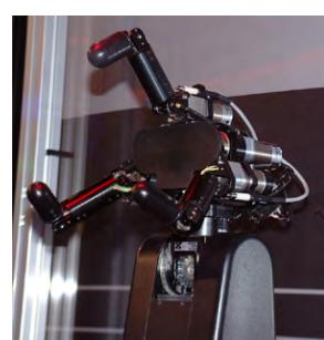
処理が可能なビジョンチップ、人間を超える高速運動が可能な高速ロボットハンド、画像情報に基づいてロボットを制御する視覚フィードバック制御の3つがキーとなる技術であり、わずか0.1秒で到達するボールを、人間の眼には見えない速度で瞬時にキャッチすることができる。
