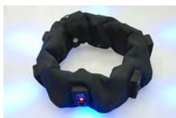
我々は、空間情報を触覚情報に変換することで、ユーザが直感的かつ自然に反応できる装着型モジュールデバイスを開発している。
