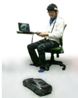
この研究はハプティックレーダープロジェクトを拡張及び補完した研究といえる。ハプティックレーダーの研究目標は、見えない障害物に対する個人の空間知覚、体の外側に向けて拡張された敏感な「光の触角」で、拡げることにあり、目で見えない領域に対しても視覚が拡張されることにあつた。本ハプティカシステムの実験装置は、センサーを表面に載せた車と、体にアクチュエーターを付けた運転手から成る。この方法で、運転手は車の周りにあるものを感じることが出来る。たとえば、車からの死角に潜む障害物の存在を、頭の後ろ側にあるアクチュエーターからの不快な刺激によって感知することが可能となる。
