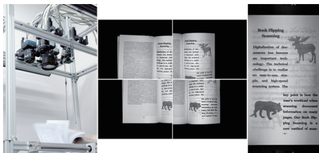
左から、システム外観、観測画像、4 視点を統合・補正した結果 Left: developed system, Center: observed images, Right: integrated & rectified image
