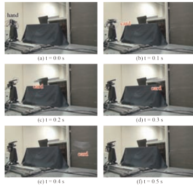
図1. カード投げの実験結果(連続写真) Figure 1. Experimental result of card throwing.
