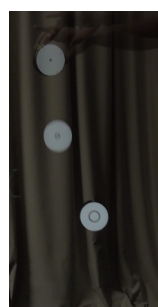
図 4 ヨーヨーの回転速度に応じてテキストの大きさを变化させ、投影した様子 Fig.4 Size-transformative projection onto a rotating yo-yo.
