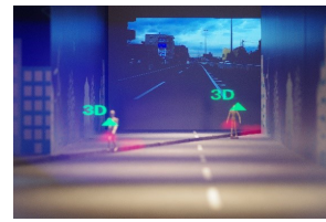
図4. 3D HUD 投影の写真(後ろに合焦)。投影内容(緑)はドライバーから複数の距離に描画可能。
