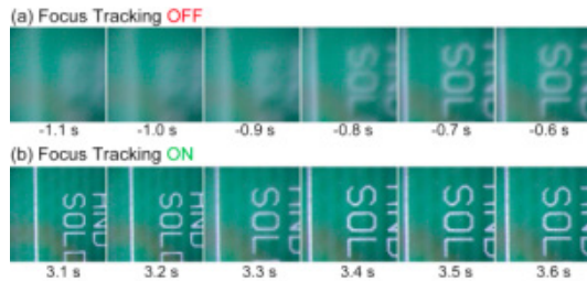
図2 高速フォーカストラッキングの実験結果。 フォーカストラッキングなしの場合の対象画像系列(a)とフォーカストラッキングを有効にした場合の対象画像系列(b)
