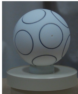
図1 球体上に配置されたUniform Circumferential Markers (UCM, 一様な円周マーカ)の様子。
