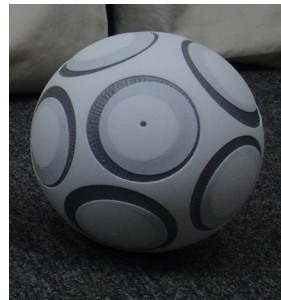
図4 球体上に配置された Biased Circumferential Markers (BCM, 偏りのある円周マーカ)の様子。
