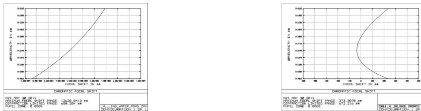
図3 (左) 単一アダプティブレンズの色による焦点距離変動 Figure 3. (Left) Chromatic focal shift of Adaptive Singlet.
