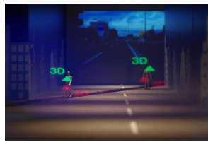
図3. 3D HUD 投影の写真(手前に合焦)。投影内容(緑)はドライバーから複数の距離に描画可能。
