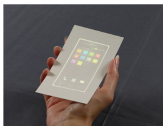
図3 動く紙に表示される映像 Fig.3 Picture displayed on a moving paper.
