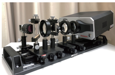
図5 液体レンズを用いた投影システムの試作機 Fig.5 Prototype of projection system using a liquid lens. (Ver.2)
